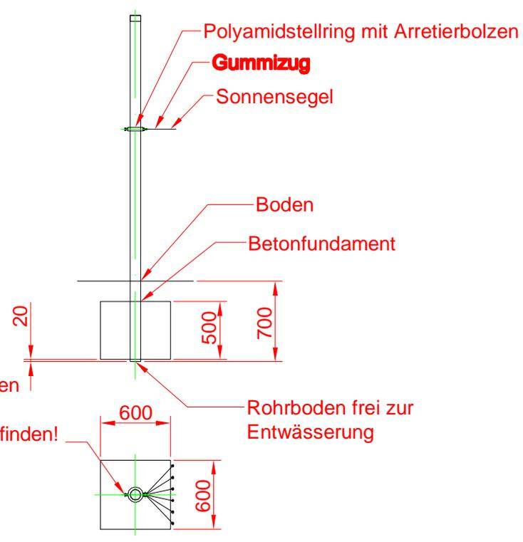
Achten sie beim einbetonieren der Pfosten darauf, dass sich die Löcher hier befinden!
